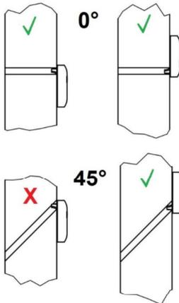
Einbaumöglichkeiten der Kabelabdeckung, die Kabelabdeckung kann prinzipiell in allen Himmelsrichtungen montiert werden.
