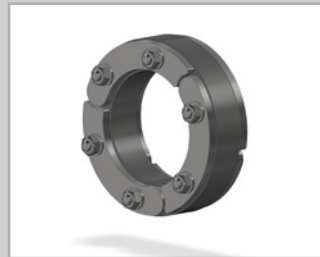
Ring-Raum-Dichtung RRD1 aus EPDM-Gummi, 20 mm gegen nicht drückendes Wasser, Metallteile aus A2-Edelstahl
